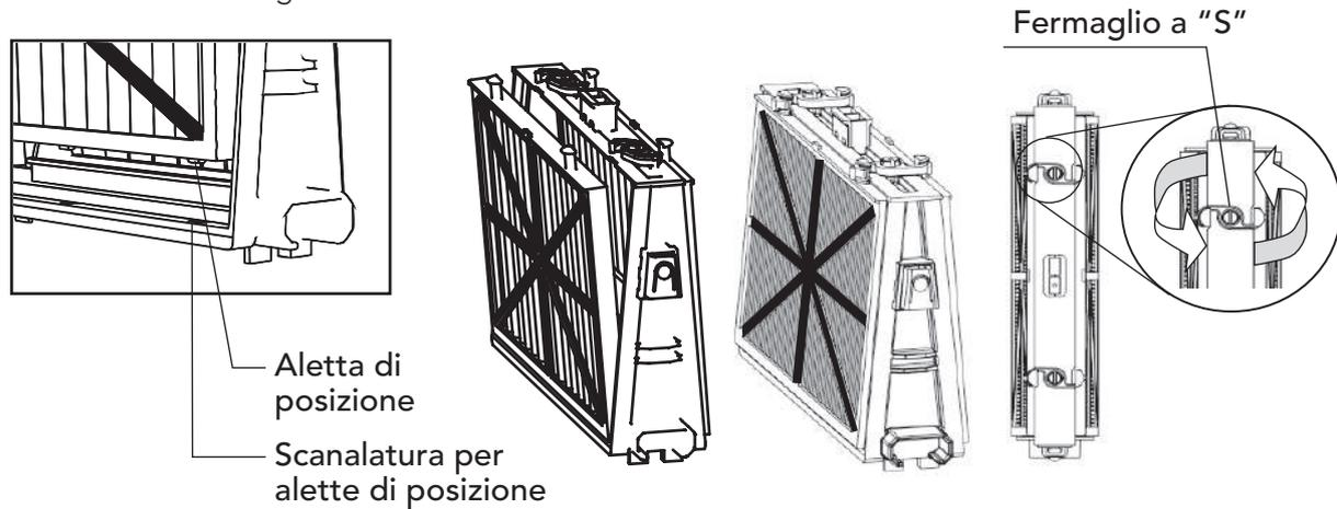
Re-installare i telai di base con i filtri secondo il diagramma.
