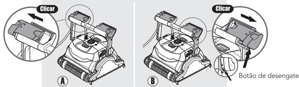
Para colocar os flutuadores de volta à sua posição original: enquanto pressiona o botão de desengate na base do flutuador da pega - empurre o flutuador da pega de volta.
