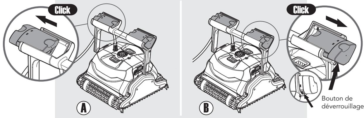
Pour remettre les flotteurs en position initiale, poussez chacun d'eux respectivement en arrière tout en appuyant sur le bouton de déverrouillage situé à sa base.
