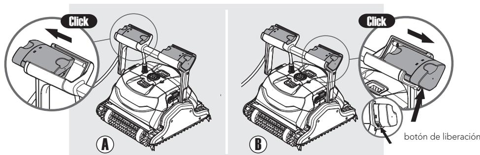
Para poner los flotadores de vuelta a su posición original: mientras presiona el botón de liberación de la base del flotador del mango - empuje el flotador del mango de vuelta.
