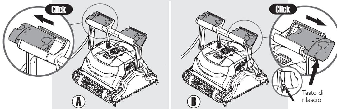
Per spostare i galleggianti di nuovo nella loro posizione originale: premendo il tasto di rilascio alla base del galleggiante del manico – spingi indietro il galleggiante del manico.
