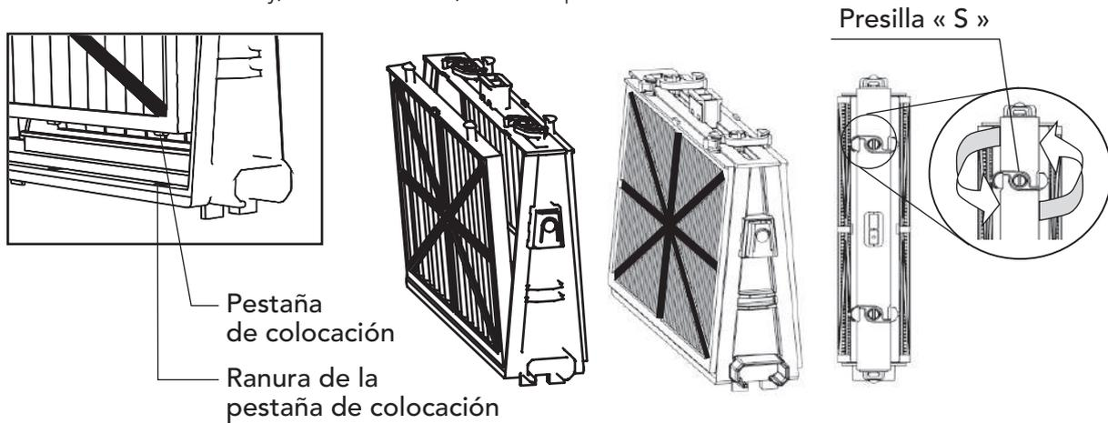
Reinstale los bastidores de base con filtros según la ilustración.
