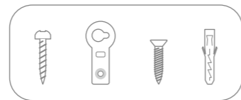
4 buchas, 4 parafusos de fixação à parede, 4 olhais de suspensão, 4 parafusos de fixação dos olhais
