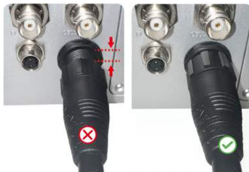
Figuur 5. Installatie celkabel
